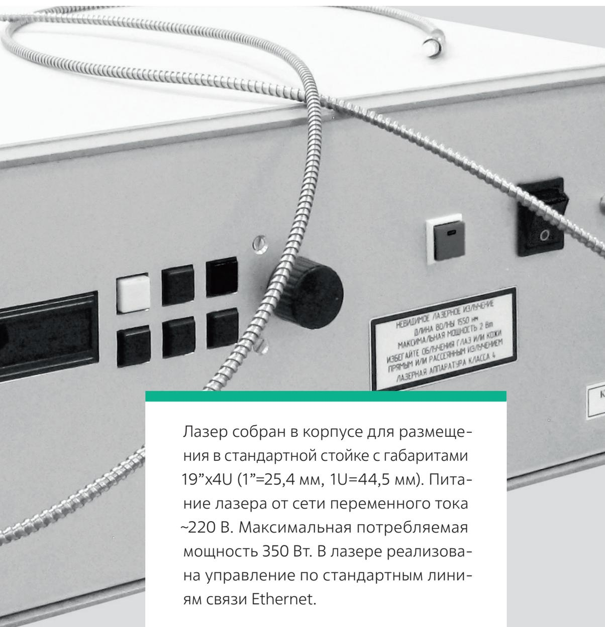
Лазер собран в корпусе для размещения в стандартной стойке с габаритами 19"x4U (1"=25,4 мм, 1U=44,5 мм). Питание лазера от сети переменного тока ~220 В. Максимальная потребляемая мощность 350 Вт. В лазере реализовано управление по стандартным линиям связи Ethernet.
